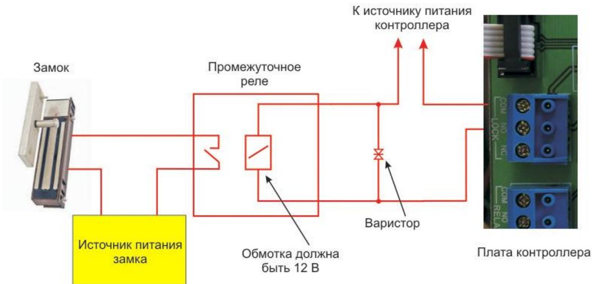
*Рисунок 13. Схема подключения замка с большим током потребления.*
