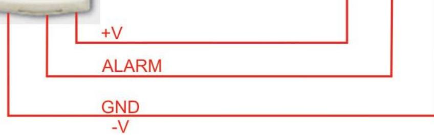
Рисунок 15б. Подключение охранного датчика без контроля подводящих проводов.
