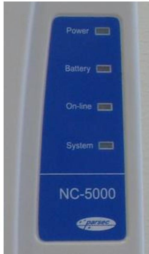
*Рисунок 20. Внешняя индикация состояний контроллера.*
