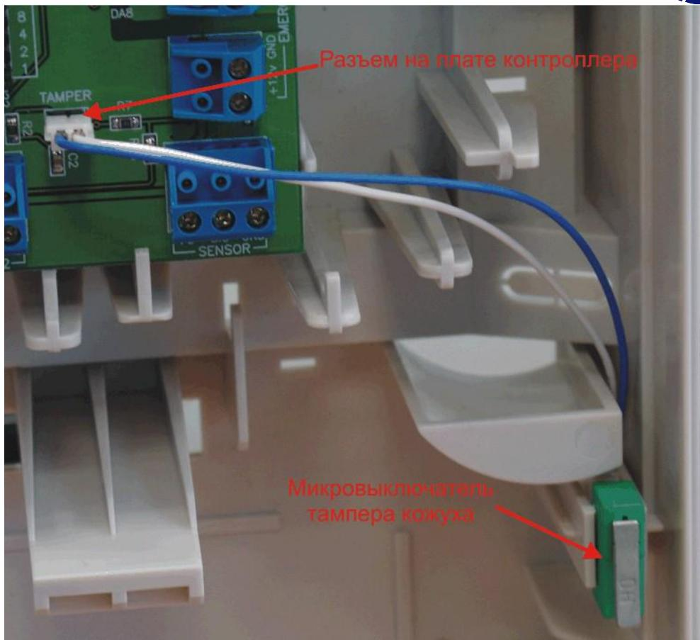
Рисунок 17. Подключение тэмпера корпуса.
