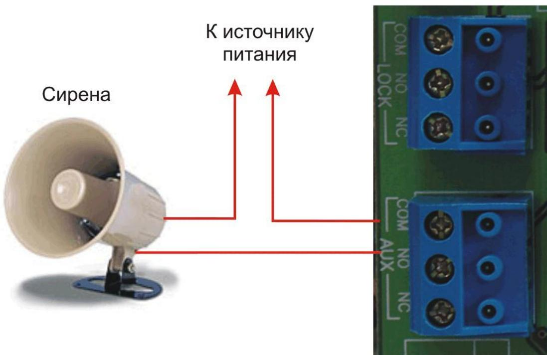
Рисунок 16. Подключение к дополнительному реле.
