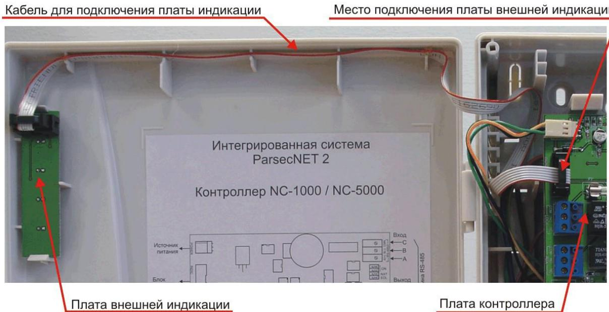
Рисунок 21. Схема подключения платы внешней индикации.
