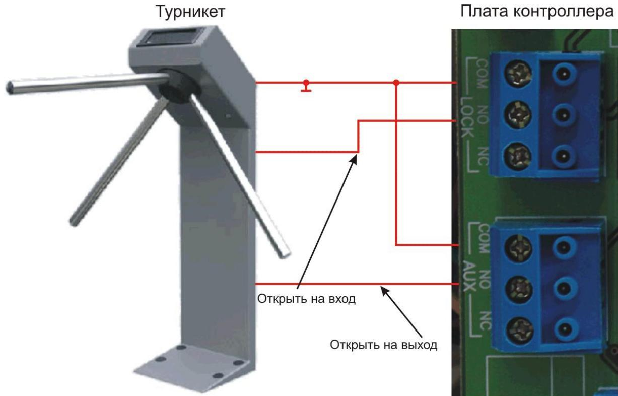
Рисунок 14. Подключение контроллера к турникуту.
