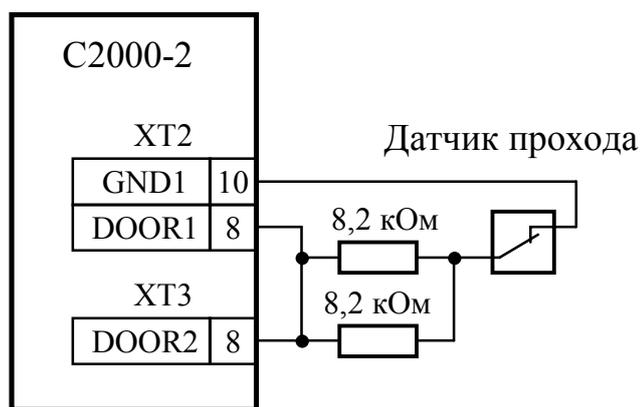
Подключение одного датчика прохода с "нормально замкнутыми" контактами
