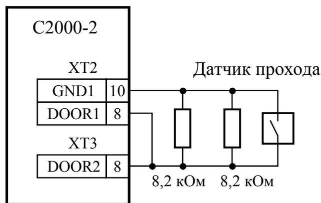
Подключение одного датчика прохода с "нормально разомкнутыми" контактами
