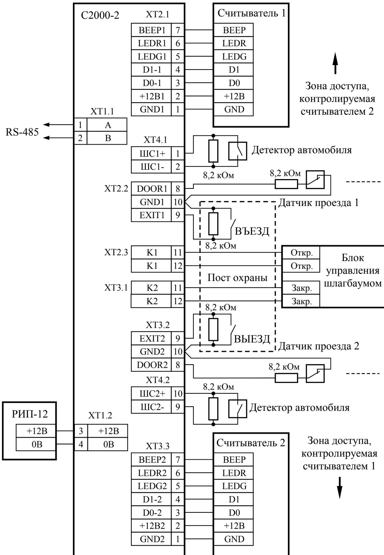
Рисунок 11 Схема подключения контроллера "С2000-2" в режиме "Шлагбаум"
