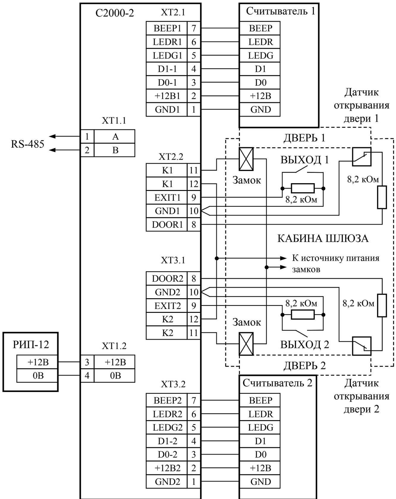
**Рисунок 13** Схема подключения контроллера "С2000-2" в режиме "Шлюз"
