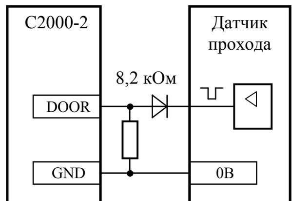
Рисунок 4 Схемы подключения датчика открывания двери (датчика прохода)
